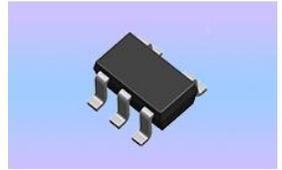
当垂直于霍尔传感器的南极磁场超过工作点时,ES2421 输出晶体管转变为低电平(输出导通),导通后输出电压是  $V_{DS}$ 。当北极磁场高于释放点  $B_{RP}$  时,输出晶体管截止(输出高电平)。磁场工作点与释放点之间的差距为器件的磁滞 ( $B_{HYS}$ )。内置磁滞防止了在转换点附近的输出振荡,而且即使在外部机械振动和电器噪声的情况下也能得到清晰的输出转换。
